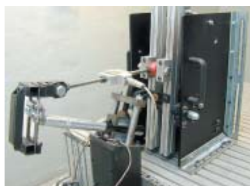
Utmattningsprovning av sadelstolpe
