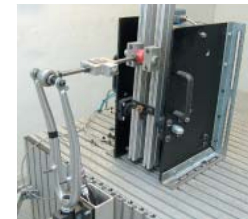
Utmattningsprovning av framgaffel
