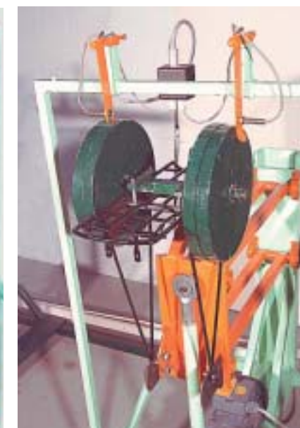
Vertikal utmattningsprovning av paketållare
