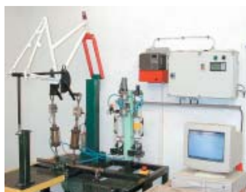
Utmattningsprovning av ramar
