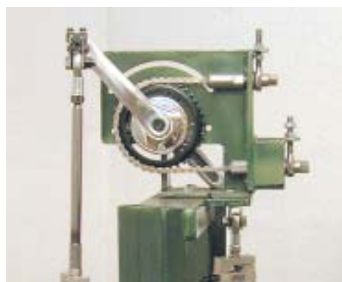
Utmattningsprovning av vevparti
